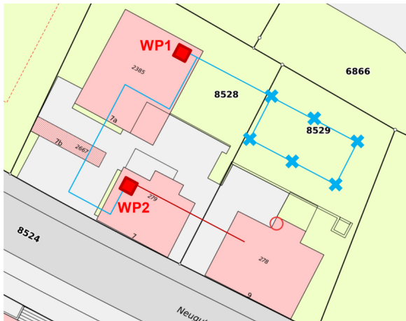
Konzeptübersicht der Wärmeerzeugung und -verteilung
