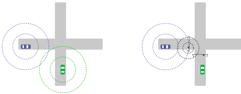
Austausch von Daten im Verkehr: Car-to-Car-Kommunikation (C2C) (links) und Car-to-Infrastructure-Kommunikation (C2I) (rechts)
